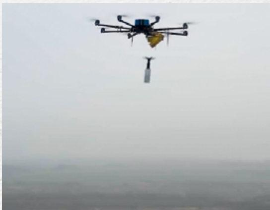
Εικόνα 8: Ουκρανικό Drone R18με Χειροβομβίδα RKG 1600 xxiii
