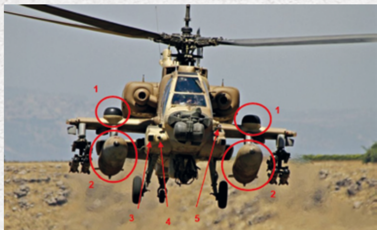
Εικ. 5. Απεικόνιση AH-64 A της ΙΑΦ. Με κόκκινο πλαίσιο και βέλη επισημαίνονται οι επεμβάσεις και οι προσθήκες επιπλέον της standard διαμόρφωσης. (Πηγή: The Times of Israel)
