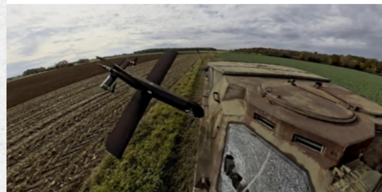
Εκ.6: ΠΠ τύπου HX-2 λίγο πριν την πρόσκρουση σε στόχο άρματος BRDM κατά τη διάρκεια δοκιμών ( https://en.defence-ua.com/weapon_and_tech/the_controversy_surrounding_the_supply_of_german_hx_2_loitering_munitions_to_ukraine_stakeholder_positions-17224.html )
